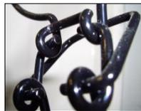
Plusieurs pièces ont un mouvement relatif, ces différents mouvements vont rompre le film de peinture en divers endroits qui pourront faire apparaître quelques manques, dans ce cas il n'y aura pas d'oxydation car le support est zingué sans défaut.
