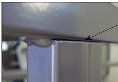
Dans ce cas non seulement la soudure est discontinue, mais les pièces (ici des tubes) ne sont pas jointives d'où le risque de voir réapparaître très rapidement des traces de corrosion dont l'origine est à l'intérieur du tube
